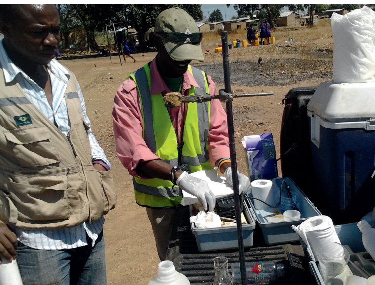
Préparation d'échantillons d'eaux souterraines pour l'analyse du tritium, Laboratoire d'hydrologie isotopique de l'AIEA, Commission ghanéenne de l'énergie atomique.
